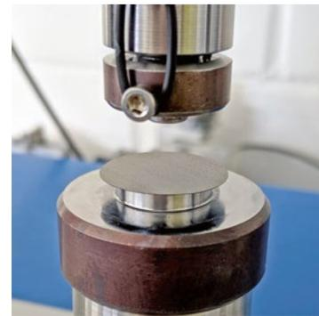
**Bild 5** Doppelring-Biegeversuch, links: eingelegte MEA-Probe, rechts: zerstörte Doppelring-Biegeprobe (Durchmesser 24 mm) (© Liensdorf)
