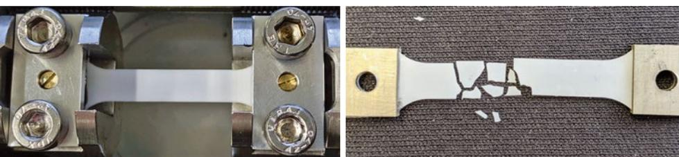
**Bild 9** links: Eingespannte Zugprobe aus  $\text{ZrO}_2$ ; rechts: versagte Zugprobe (© Liensdorf)
