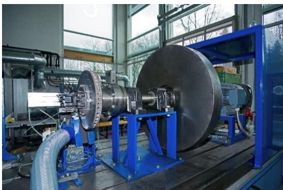
Bild 1: Versuchsaufbau am Bremsenprüfstand der Universität Bayreuth (Schwungmasse = 800 kg ( J = 96 \text{ kgm}^2 ), Bremsscheibendurchmesser: 420 mm)
