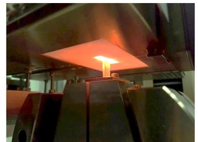
Zugversuch im Kurzofen bei 1000 °C
